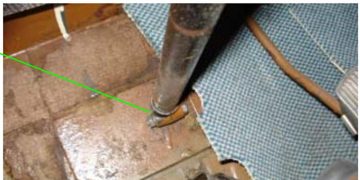
9. Egal, ob sie nur eine Korrektur der Lenkradeinstellung vornehmen wollen oder der Blinkerschalter nicht in der gewünschten Position steht und (oder) möglicherweise auch nicht richtig in die Neutralstellung zurückspringt; In jedem Fall lösen sie den Klemmbügel, der das Führungsrohr am Armaturenbrett fixiert ganz und ziehen sie die Lenksäule samt Führungsrohr aus der Sternverzahnung im Fussraum heraus.
