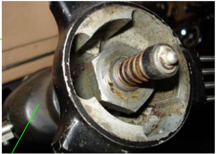
6. Nun die drei Schrauben der Schutzhaube über dem Blinkerschalter lösen und Haube abnehmen.
