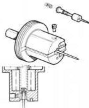
Federbelastete Düsennadeln haben am oberen Ende ihrer Aufnahme einen Ring aufgedrückt, der gleichzeitig als Halter für die Feder sowie auch als Auflage auf den Nadelhalter dient. Auch diese Nadeln haben einen erkennbaren Absatz zwischen Aufnahme und "Dosierteil". Dieser Absatz muß, wie bei den starren Nadeln, auch grundsätzlich bündig mit dem Kolbenboden sein, wenn die Nadel montiert ist.
