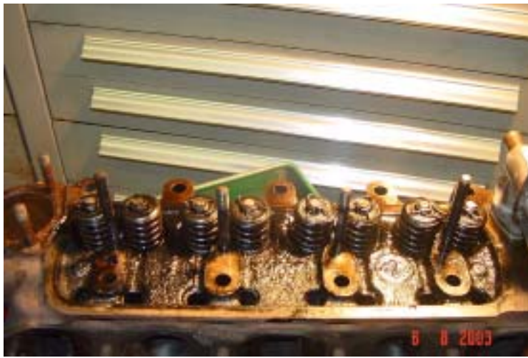
26 Ansicht von der Ventildeckelseite her. Der noch ungereinigte Zylinderkopf mit den noch nicht demontierten Ventilen
