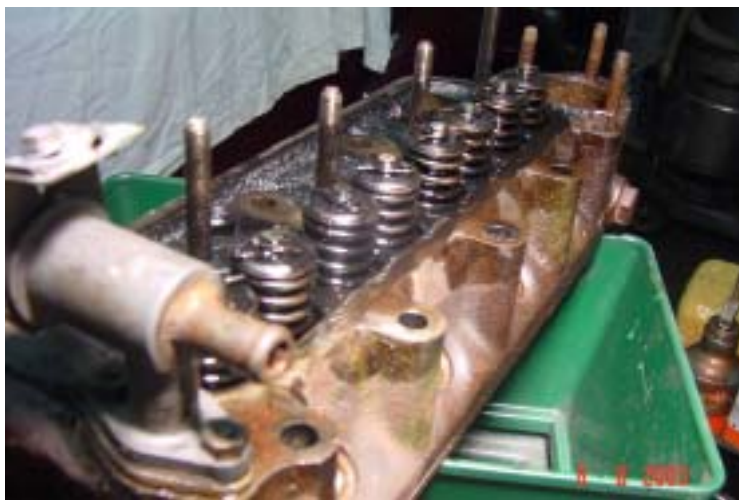
28 Am Heizhahn ist schwach ein kleines, undefinierbares Teil im Schlauchanschluss sichtbar. Auffallend ist die starke dunkle Ölkruste auf der Oberfläche des Kopfes.
