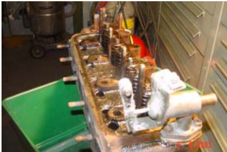
27 im Vordergrund ist der Heizhahn mit dem Zughebel zu erkennen. Diesen werden wir später noch genauer unter die Lupe nehmen.
