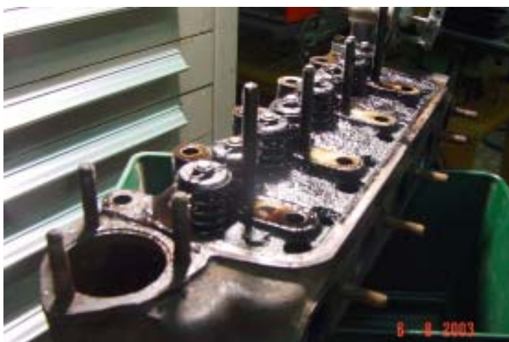
29 von der Gegenseite ist der fast teerartige Belag deutlich sichtbar. Das lässt auf eine frühere Überhitzung des Zylinderkopfes schließen, oder aber das Öl wurde zu selten gewechselt. Eine weitere Möglichkeit könnte ein fehlender oder falsch montierter Ölfilter sein, so dass das ungefilterte Öl in den Ölkreislauf gelangt.
